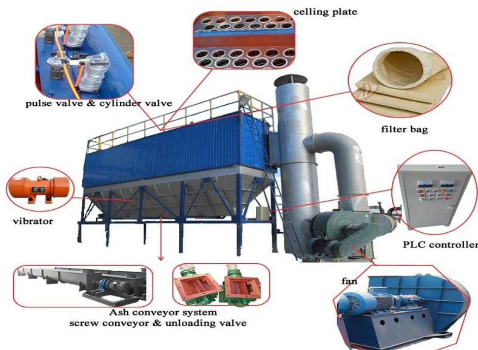
شکل ۱. اجزای غبارگیرهای صنعتی
