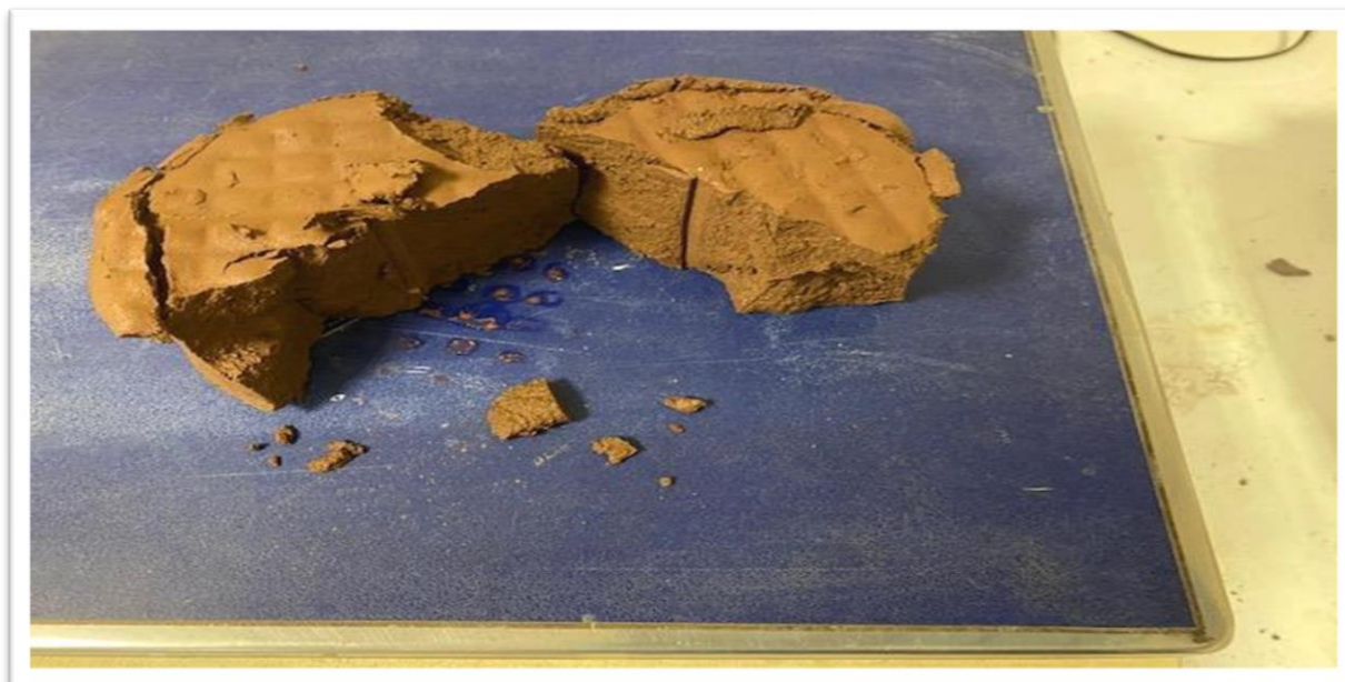
تصویر ۷- کیک تولید شده از مواد جامد فیلتر شده در فیلتر پرس
